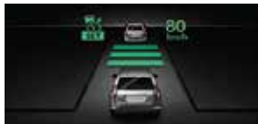
สัญลักษณ์แสดงการทำงานของระบบ ACC บนมาตรวัด
